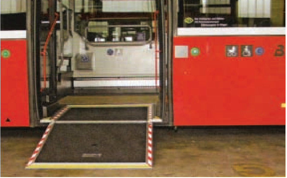
Fotoğraf 18: El kontrollü, alçak tabanlı otobüs rampası
