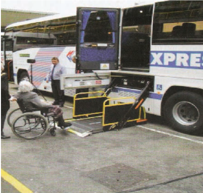
Fotoğraf 20: Taşıta monte edilen liftler aracılığıyla yüksek tabanlı bir yolcu otobüsüne erişim mümkün olmaktadır.
