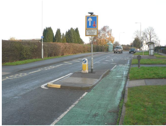
Şekil 4.5. Loughborough'daki yolların daraltılması (İngiltere)
